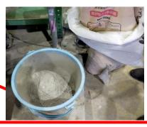
ベースのコンクリートを B 種高炉セメントコンクリートにする事で CO2排出抑制
