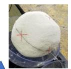
繊維を混入する事で、レーンに 衝突した時の衝撃による剝離 防止・引張強度の増加を期待し た。
